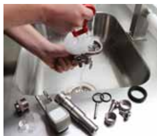
Abb. 6: Zerlegter Zapfkopf zur gründlichen Reinigung
