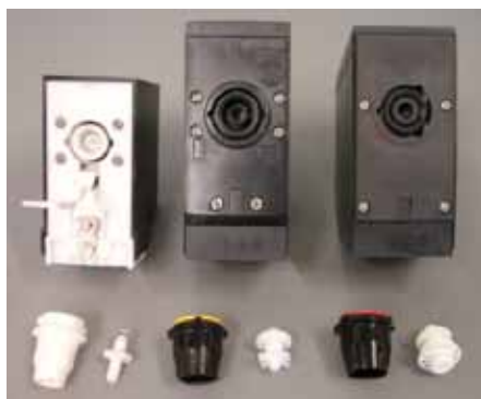
Abb. 5: Zerlegte Zapfhähne (Bier, Postmix) zur gründlichen Reinigung
