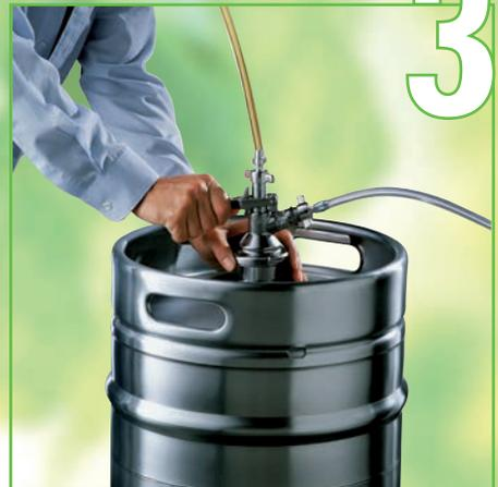
Den Zapfhahn bis zum Anschlag über den Verschluss schieben und den Hebel nach unten drücken.
